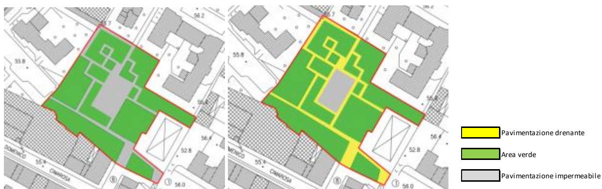
Figura 45: Sinistra: Planimetria stato di fatto area parco in via Vivaldi; Destra: Planimetria stato di progetto PROGETTO PRATO PIU'
