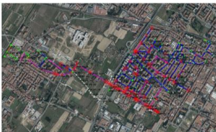
Figura 11. Funzionamento della rete fognaria per diversi tempi di ritorno. Le aree in rosso evidenziano pozzetti previsti con funzionamento in pressione
