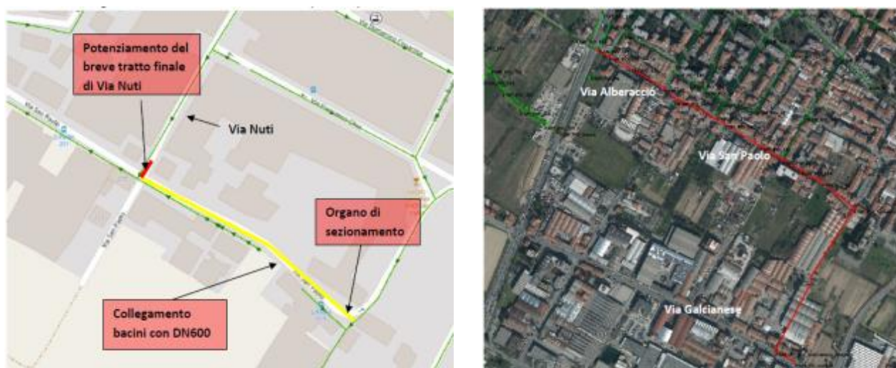
Figura 13. Planimetria della condotta di progetto (sinistra), Planimetria tratto profilato (destra) - Fonte: Publiacqua
