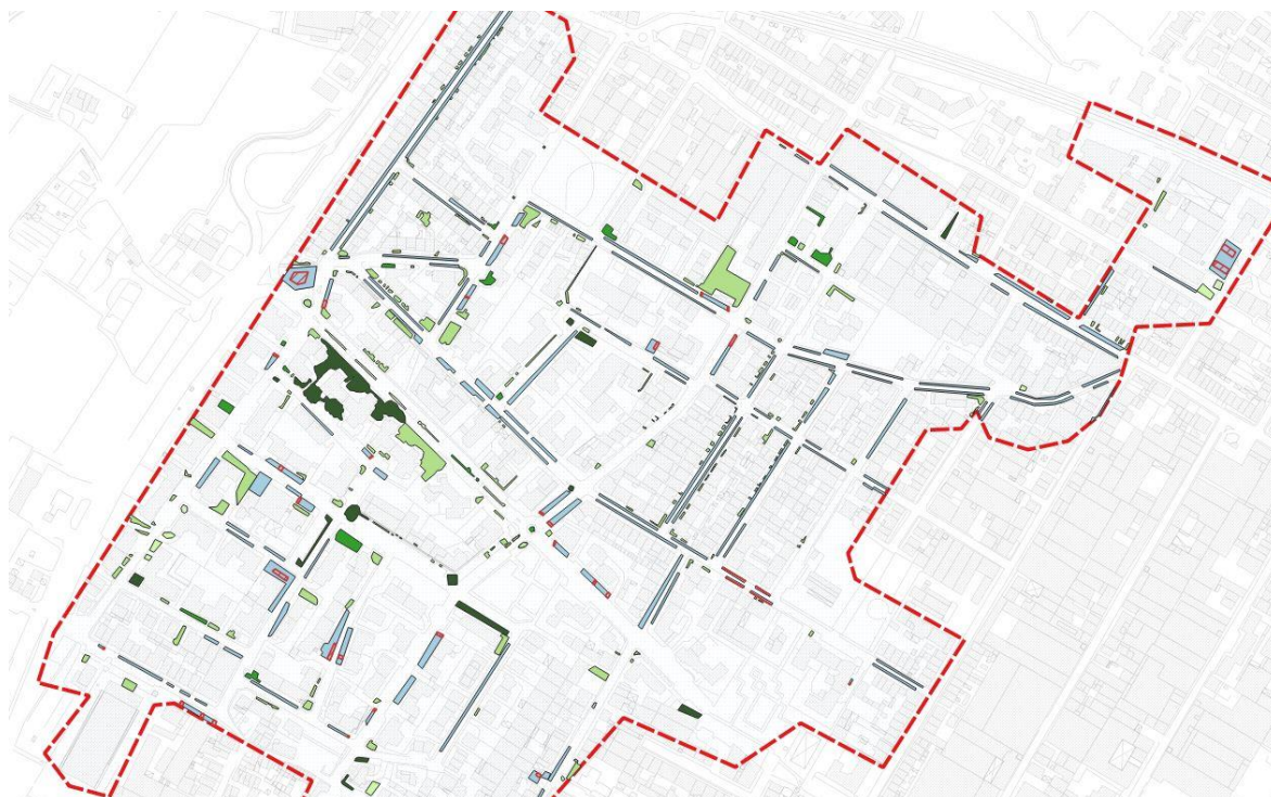
Figura 58. Alternativa 1, target evento con tempo di ritorno 5 anni (2798 mc). Occupazione area retrofitting SuDS, 2.8% del bacino drenato. N° interventi diffusi: 412. In azzurro in parcheggi interessati da interventi di retrofitting di tipo A. Quindi solo il 5% dell'area mostrata è previsto che venga dedicata a SuDS.
