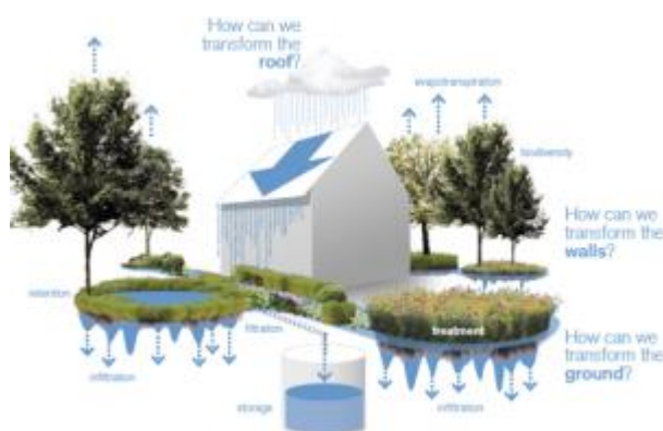
Figura 29. Tipologico elementi SuDS adottabili per singole abitazioni
