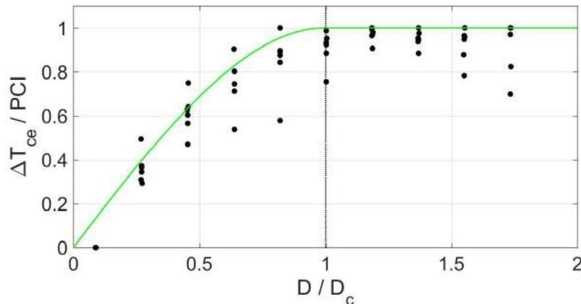
Figura 5.11:14 - Grado di variazione termometrica  $\overline{\Delta T_{ce}}$  normalizzata rispetto alla PCI in funzione della distanza da aree verdi normalizzata rispetto al cooling distance
