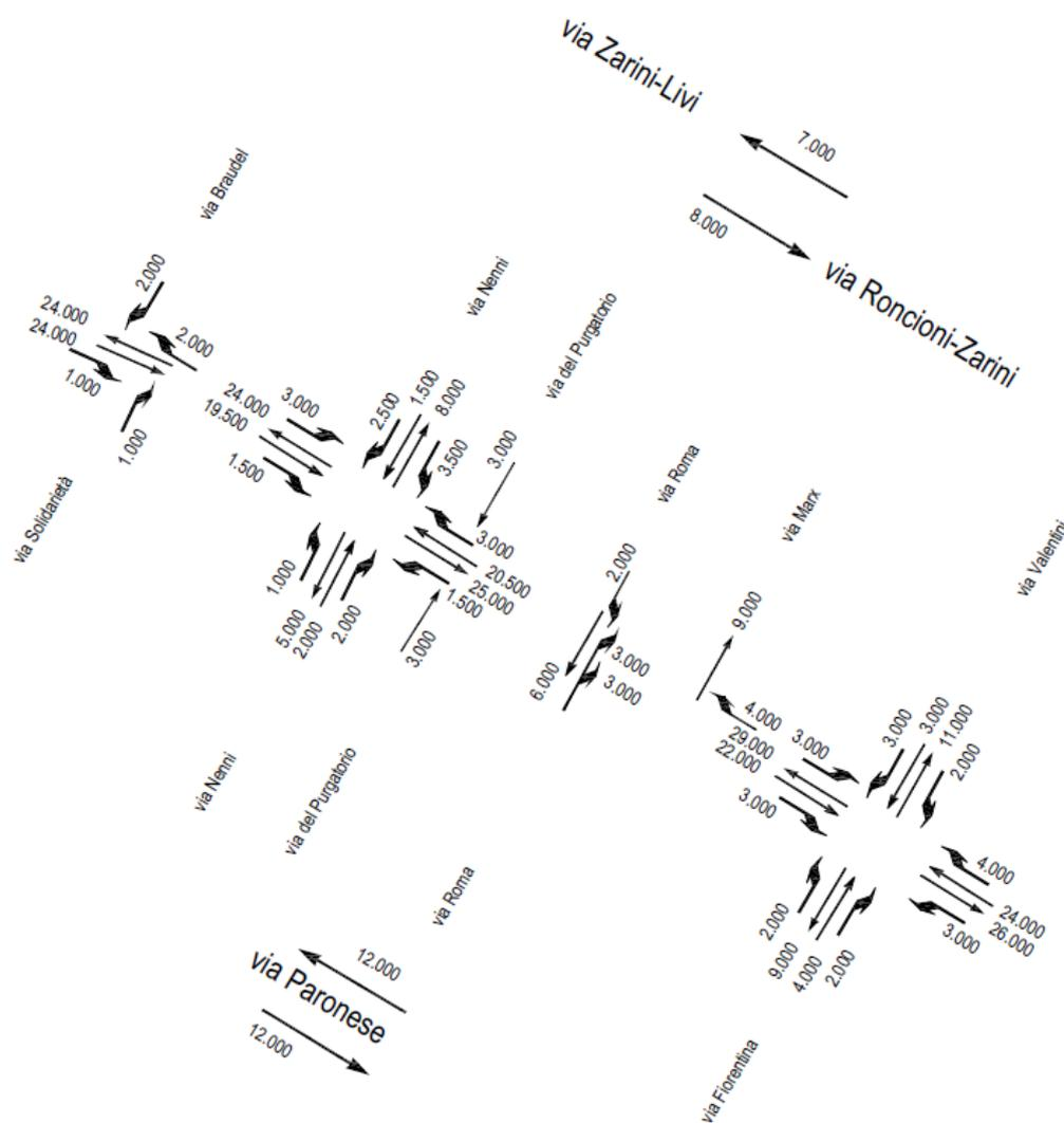
Figura 2-6 Schema flussi della circolazione stradale
