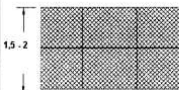
RECINZIONE IN GRIGLIATO METALLICO
